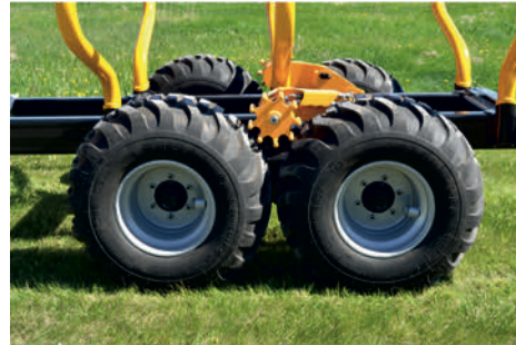
4WD hydraulischer Reibradantrieb
