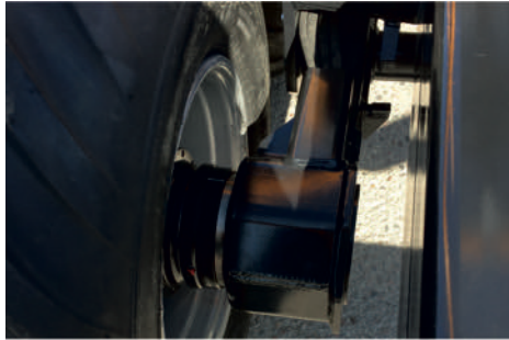
2WD hydraulischer Radnabenantrieb Black Bruin
